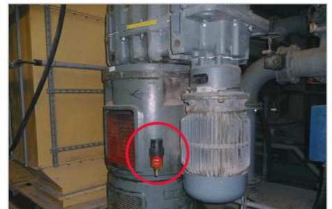
Wälzlagerschmierung am Rührwerk
