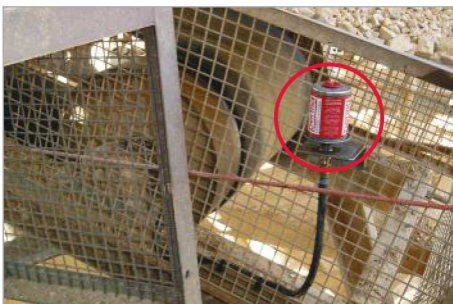
Stehlagerschmierung einer Förderbandanlage
