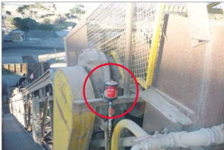
Stehlagerschmierung der Drucktrommel
