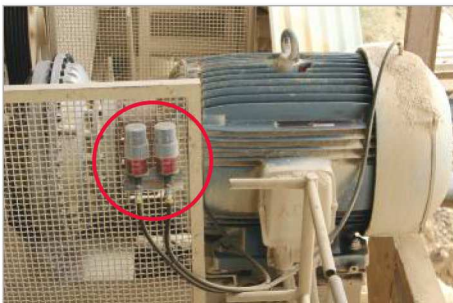
Indirekte Schmierung eines Elektromotors
